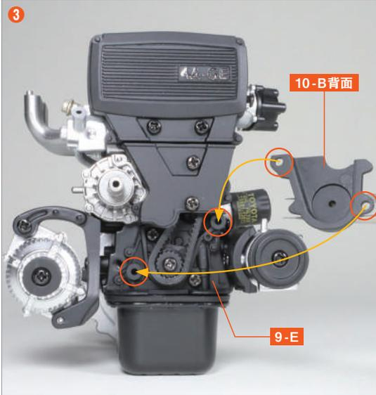
將正時皮帶外蓋1 10-B 的兩個孔對準油泵 9-E 的螺絲孔，將 10-B 套在 9-E 上。
