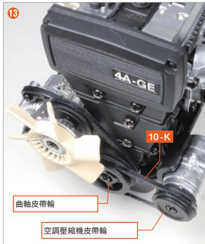
在稍微拉長空調壓縮機皮帶 10-K 的同時，將其掛在曲軸皮帶輪和空調壓縮機皮帶輪的溝槽中嵌入。
