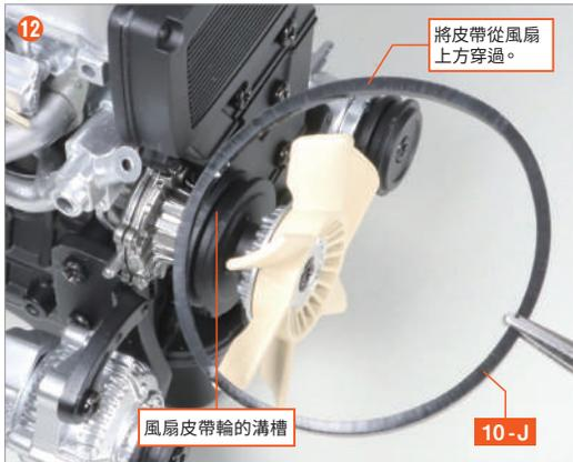
將風扇皮帶 10-J 掛在風扇皮帶輪的溝槽中。然後，稍微拉長 10-J，同時掛在發電機滑輪和曲軸皮帶輪的後方溝槽中。
