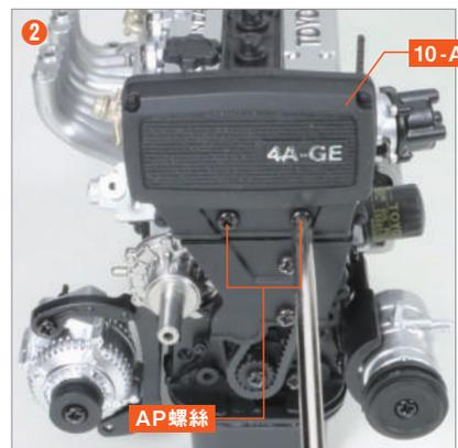
對準 9-C 和 10-A 的螺絲孔，使用 AP螺絲 在兩處進行固定。
